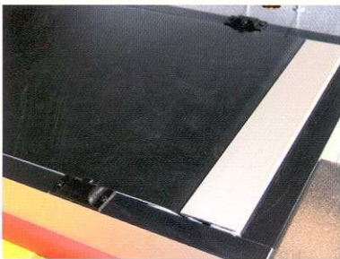
Фотоэлемент для автоматической остановки транспортной ленты
